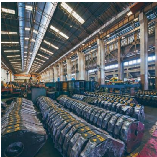
ภาพที่ 16 และภาพที่ 17 สภาพภายในอาคารโรงรถจักร 1 (โรงซ่อมรถจักรดีเซลไฮดรอลิก) ลักษณะเป็นอาคารชั้นเดียว ผนังของอาคารเป็น รูปสี่เหลี่ยมผืนผ้าแคบยาว ใช้โครงสร้างระบบเสาคานคอนกรีตเสริมเหล็กขนาดใหญ่ หลังคาเป็นโครงเหล็กถัก (Truss) (การรถไฟแห่งประเทศไทย, 2564)
