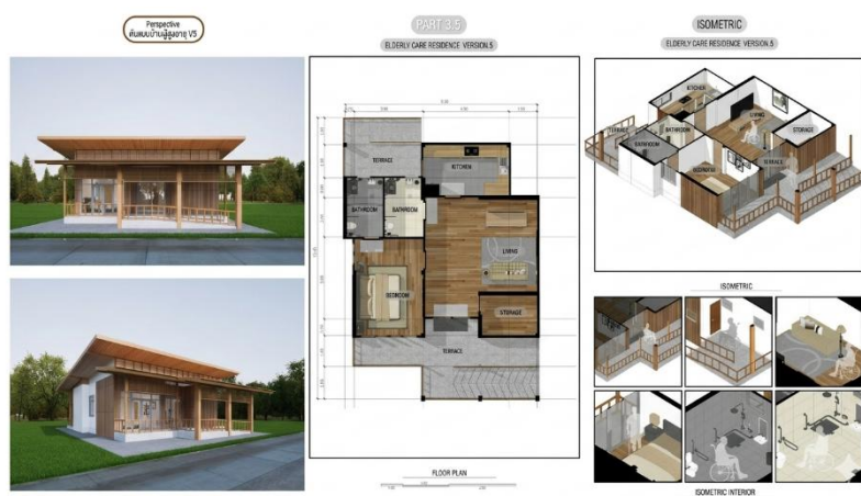
ภาพที่ 10 การออกแบบพัฒนาที่พักอาศัยสำหรับผู้สูงอายุ แบบที่ 4 สำหรับบ้านเพื่อสุขภาพ
