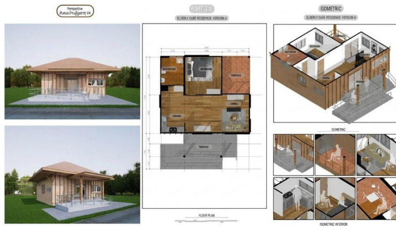
ภาพที่ 10 การออกแบบพัฒนาที่พักอาศัยสำหรับผู้สูงอายุ แบบที่ 4 สำหรับบ้านเพื่อสุขภาพ
