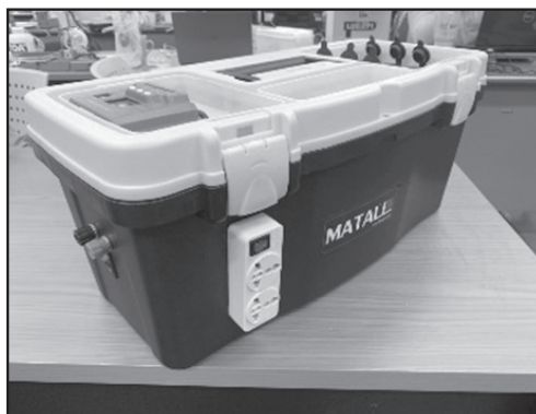
ภาพที่ 8 การประกอบปลั๊กเต้ารับสามตา 2 ช่อง
