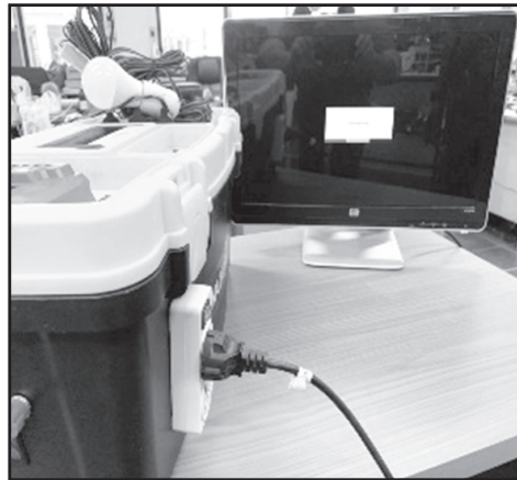
ภาพที่ 12 การทดสอบใช้งานอุปกรณ์สำรองไฟฟ้าเคลื่อนที่
