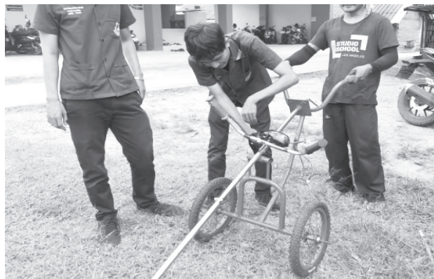
ภาพที่ 4 การตรวจสอบการใช้งานเบื้องต้น รถเข็นตัดหญ้าไฟฟ้าอเนกประสงค์
