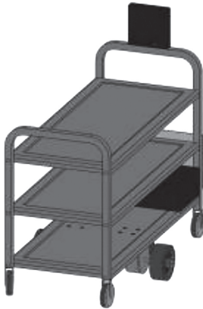
ภาพที่ 1 รถเข็นส่งของบังคับระยะไกลสำหรับผู้ป่วยระบบทางเดินหายใจ
