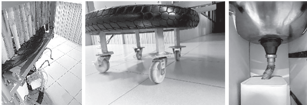
ภาพที่ 5 โครงสร้างส่วนมือจับในการเข็นเคลื่อนย้ายชิ้นงาน ส่วนโครงสร้าง 4 ล้อ และระบบถังกรองน้ำ
