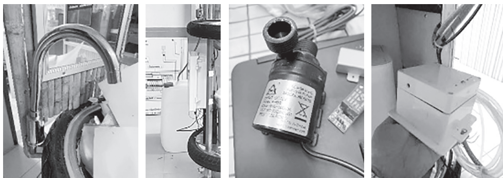
ภาพที่ 6 โครงสร้างส่วนของก๊อกน้ำอัตโนมัติ ปั้มน้ำและถังกลลอนใส่น้ำสำรองขนาด 30 ลิตร
