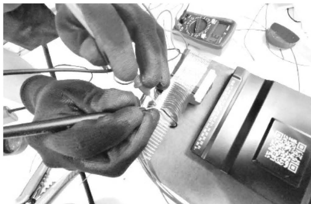
ภาพที่ 5 การตรวจสอบจุดเชื่อมต่อของสายบัสบาร์ใน Smart BMS
