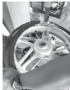
ภาพที่ 2 ขั้นตอนการเปลี่ยนยางเก่าด้วยเครื่องถอดเปลี่ยนยางชนิด Tubeless Tire – TL
