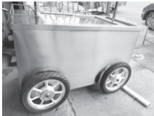
ภาพที่ 5 การสร้างล้อและช่วงล่างฐานล้อ
