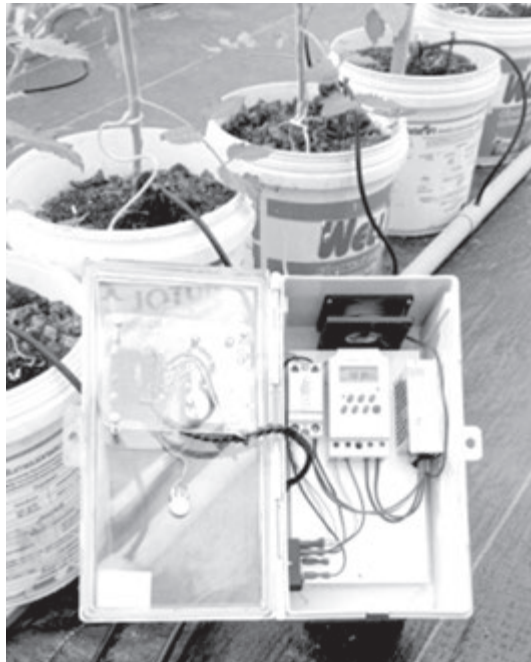
ภาพที่ 7 ทดสอบอุปกรณ์ช่วยผสมเกสรต้นมะเขือเทศในโรงเรือน
