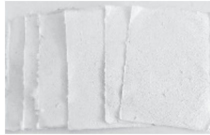
ภาพที่ 2 ก. การทำบรรจุภัณฑ์เส้นใยไบโอเซลลูโลสด้วยและเส้นใยหญ้าขจรจบด้วยวิธีการซ้อนเยื่อ ข. บรรจุภัณฑ์จากเส้นใยไบโอเซลลูโลสด้วยและเส้นใยหญ้าขจรจบ
