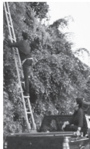
ภาพที่ 8 ทดลองใช้ชุดต้นแบบอุปกรณ์ช่วยจับยึดบันไดบนรถกระบะ
