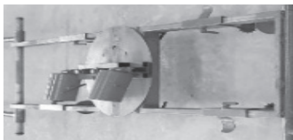
ภาพที่ 2 โครงสร้างส่วนฐานของอุปกรณ์ช่วยจับยึดบันไดบนรถกระบะ
