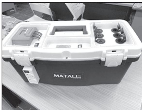
ภาพที่ 13 อุปกรณ์สำรองไฟฟ้าเคลื่อนที่ ที่เสร็จสมบูรณ์
