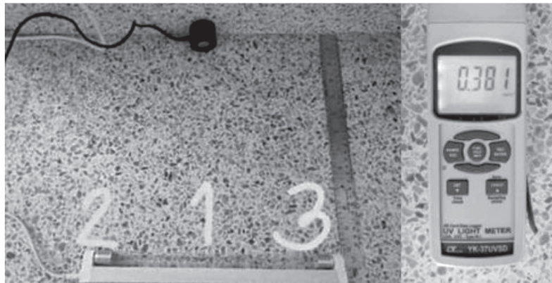
ภาพที่ 8 ผลการทดสอบความเข้มของคลื่นแสง UVC
