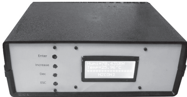
ภาพที่ 2 เครื่องควบคุมความชื้นด้วยแก๊สไนโตรเจนในตู้เก็บชิ้นงานอิเล็กทรอนิกส์ที่สร้างขึ้น
