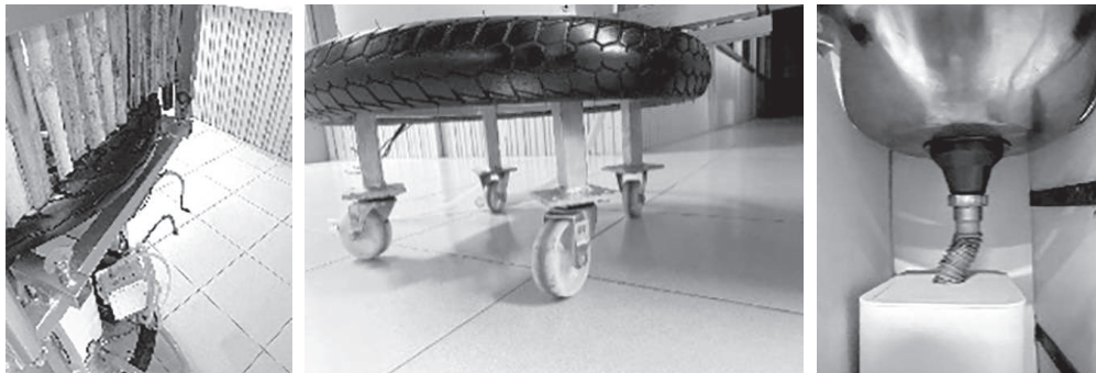
ภาพที่ 5 โครงสร้างส่วนมือจับในการเข็นเคลื่อนย้ายชิ้นงาน ส่วนโครงสร้าง 4 ล้อ และระบบถังกรองน้ำ
