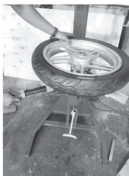
ภาพที่ 3 ขั้นตอนการใส่ยางเส้นใหม่โดยเครื่องถอดเปลี่ยนยางชนิด Tubeless Tire – TL
