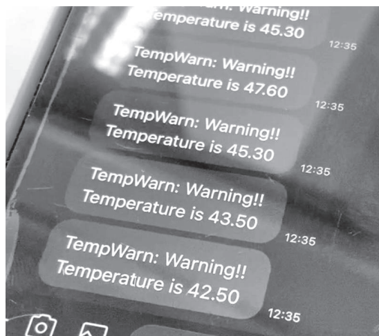
ภาพที่ 4 หน้าจอแสดงผลแจ้งเตือนอุณหภูมิภายในห้องเซิร์ฟเวอร์ที่มีค่าสูงกว่าเกณฑ์ผ่าน Line Notify
