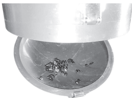
ภาพที่ 4 เศษวัชพืชและเศษหอยที่ถูกดักเก็บในถังเก็บของอุปกรณ์ เมื่อสูบน้ำด้วยอุปกรณ์
