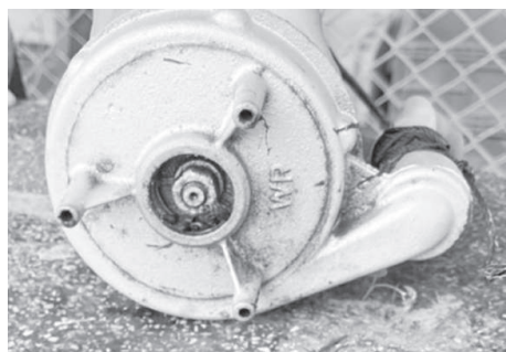
ภาพที่ 5 เศษวัชพืชและเศษหอยติดุดตันบริเวณหน้าตะแกรงปั๊มจุ่ม เมื่อสูบน้ำโดยไม่ใช้อุปกรณ์
