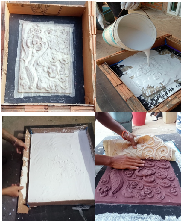
ภาพที่ 5 ขั้นตอนการเทพิมพ์ และถอดแม่พิมพ์
